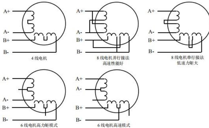
图 6 电机接线图
