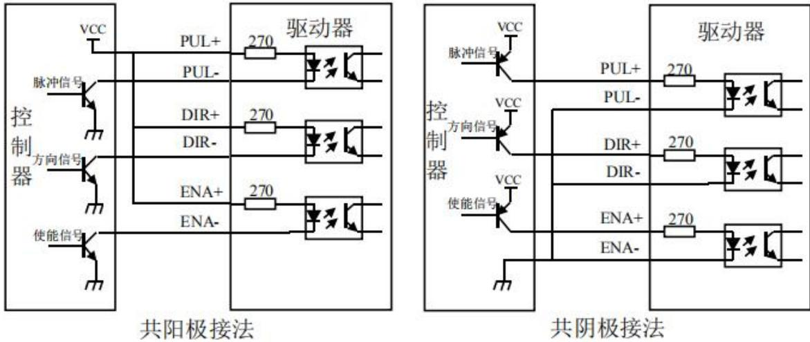
图2 输入接口电路
