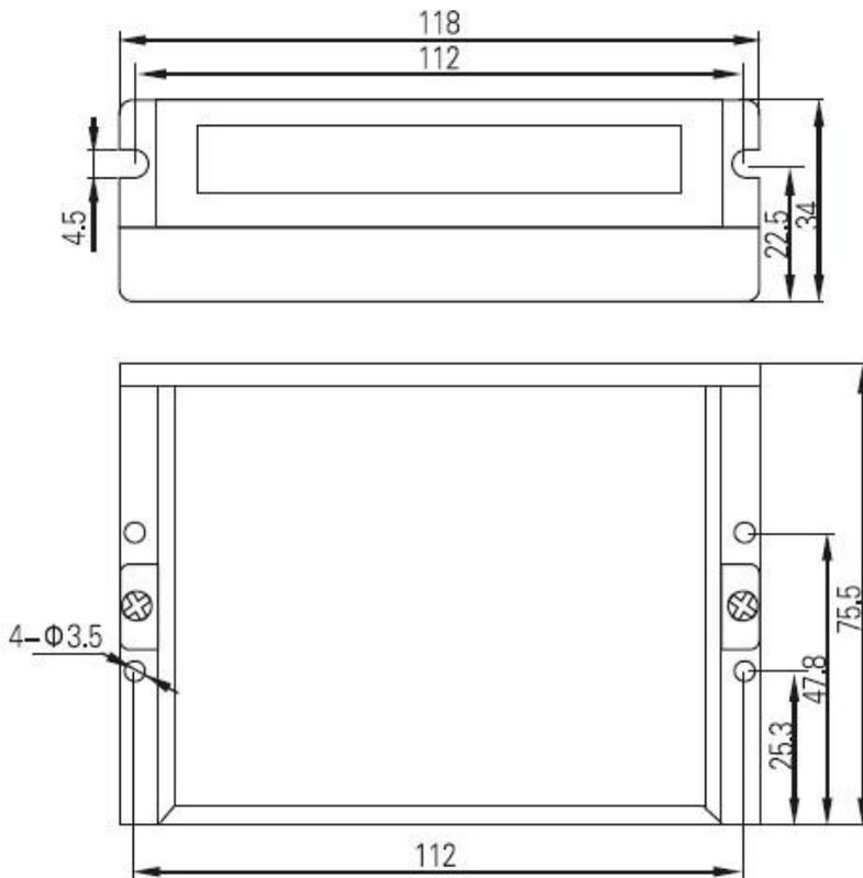
图 1 安装尺寸图 (单位: mm)
